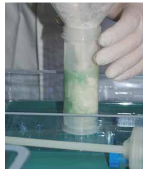
Abb. 1: Nach dem Mischen von Pulver und Flüssigkeit findet eine Reaktion zwischen dem Starter (BPO) und dem Initiator (DmpT) statt
